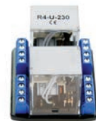
Relais für vier Motoren - keine Einzelbedienung möglich Maße 50 x 55 x 42 mm
