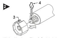
Wellen-Kupplung (3) auf Getriebebolzen schieben und durch Clip (4) sichern.
