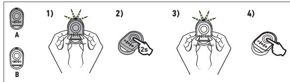
جهاز التشغيل عن بعد "أ" = جهاز التشغيل عن بعد "المصدر" المخزن بالذاكرة مسبقاً
